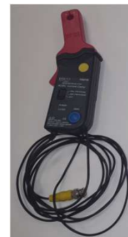
20 A / 60 A DC (basso amperaggio) pinza di corrente
